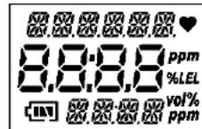
警報ランプ、故障ランプが点灯し、LCD 表示が全点灯となります。
